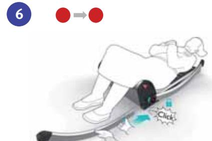
Disponga la pata delantera (marcada en rojo, para el lado marcado con dicho color) hacia el asiento y encájela hasta oír click.
