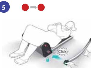
Empuje la pata trasera (marcada en rojo, para el lado marcado con dicho color) hacia el eje hasta que oiga click.
